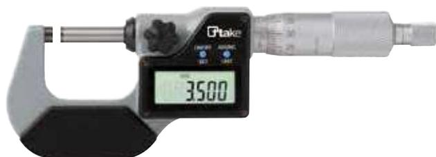
**MICROMETRO DIGITALE IP65**, resistente alla polvere e all'acqua. Misurazione assoluta/incrementale in qualunque posizione. Tamburo graduato cromato opaco. Frizione sensitiva. Nottolino di bloccaggio. Arco con guanciali termoisolanti. Stelo  $\varnothing$  6,5 mm. Superfici di contatto riportate in metallo duro. Tasti: on/off – zero/abs – mm/pollici – unit. Risoluzione 0,001.
